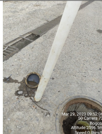
Foto 26. Pozo de monitoreo 1 (PM1), sin evidencia de producto en fase libre o iridiscencia y escasa agua.
